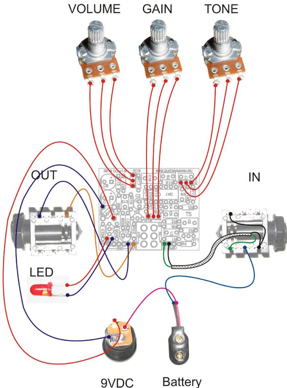
Для коммутации входного гнезда используется экранированный провод МСЭО16-13, средняя жила которого соединяет паячную точку IN платы и сигнальный вывод гнезда, а оплетка аккуратно скручивается в жгут и запаивается на точку GND и на земляную клемму гнезда. Для остальных соединений используется провод МГШВ.
