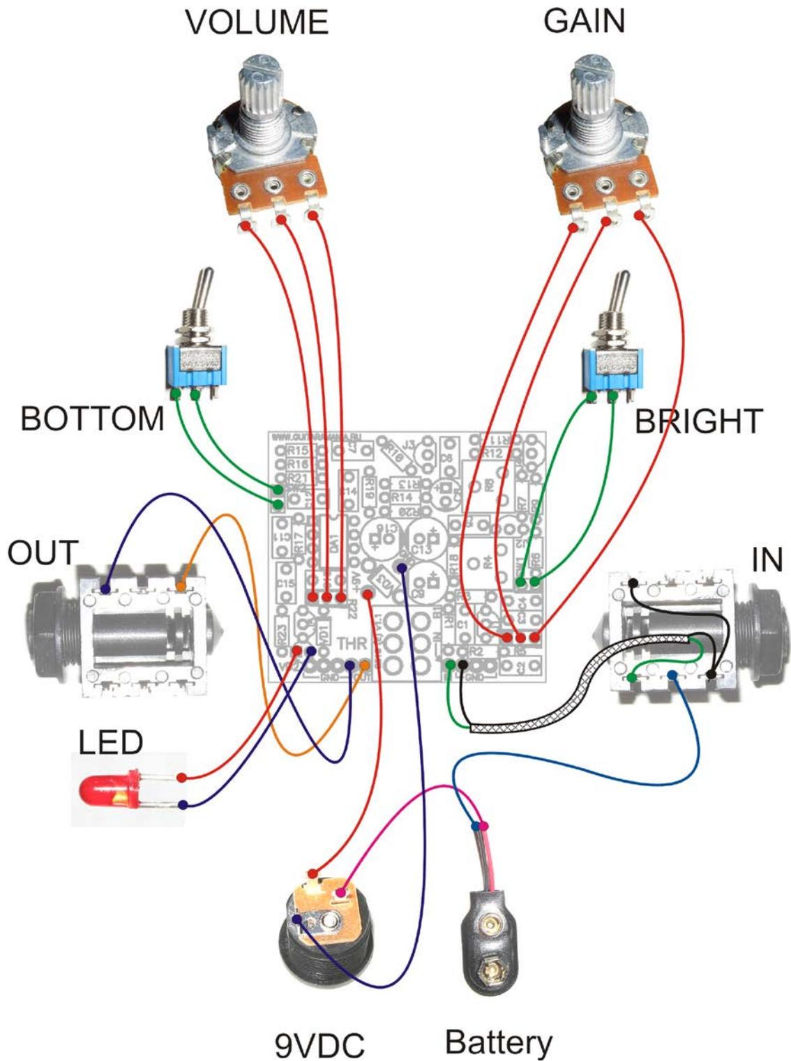
Для коммутации входного гнезда используется экранированный провод МСЭО16-13, средняя жила которого соединяет паечную точку IN платы и сигнальный вывод гнезда, а оплетка аккуратно скручивается в жгут и запаивается на точку GND и на земляную клеему гнезда. Для остальных соединений используется провод МГШВ.
