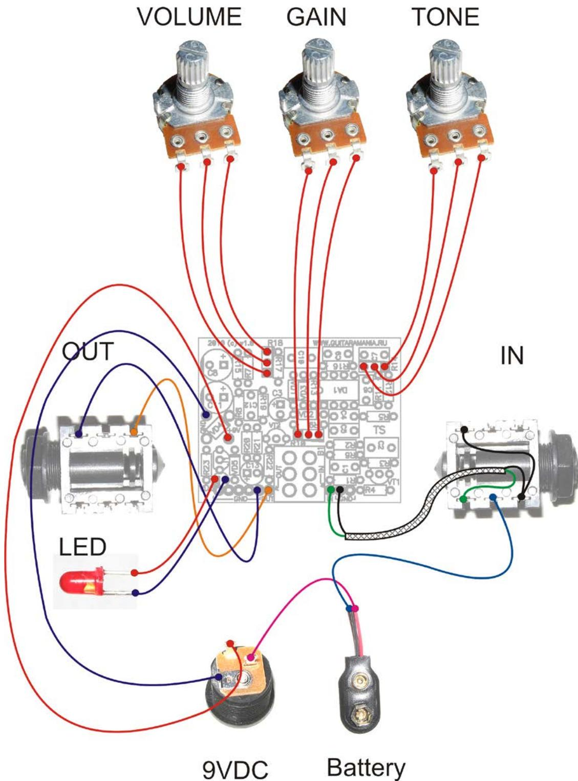
Для коммутации входного гнезда используется экранированный провод МСЭО16-13, средняя жила которого соединяет паячную точку IN платы и сигнальный вывод гнезда, а оплетка аккуратно скручивается в жгут и запаивается на точку GND и на земляную kleemу гнезда. Для остальных соединений используется провод МГШВ.
