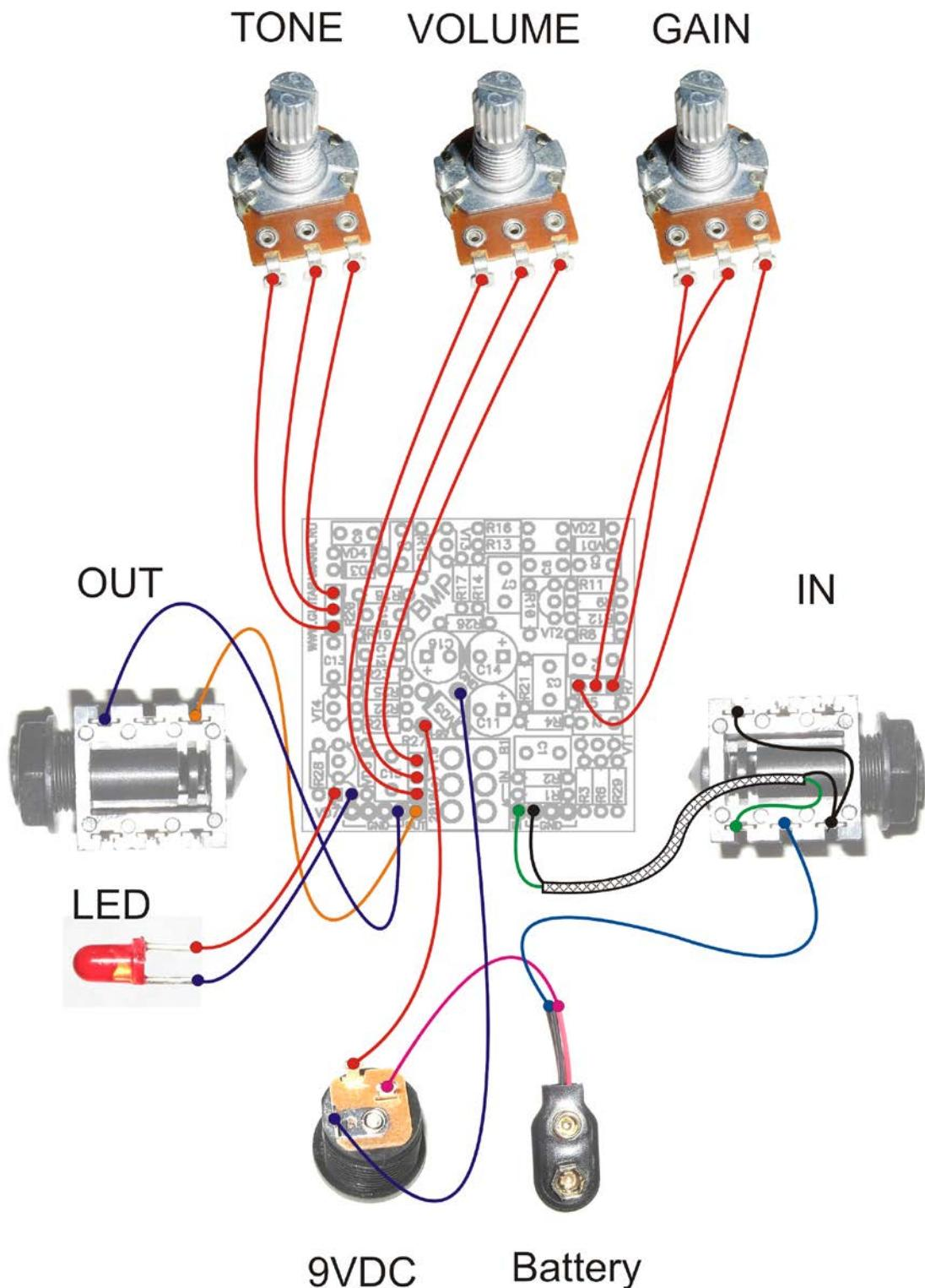
Для коммутации входного гнезда используется экранированный провод МСЭО16-13, средняя жила которого соединяет паячную точку IN платы и сигнальный вывод гнезда, а оплетка аккуратно скручивается в жгут и запаивается на точку GND и на земляную kleemу гнезда. Для остальных соединений используется провод МГШВ.
